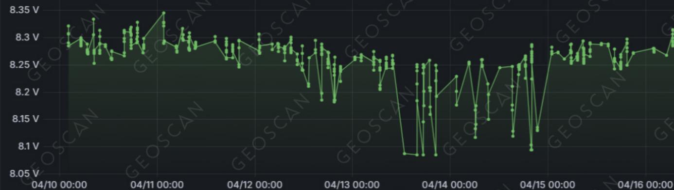
Напряжение батарей Mean: 8.26 V Last \*: 8.27 V Max: 8.35 V Min: 8.09 V
